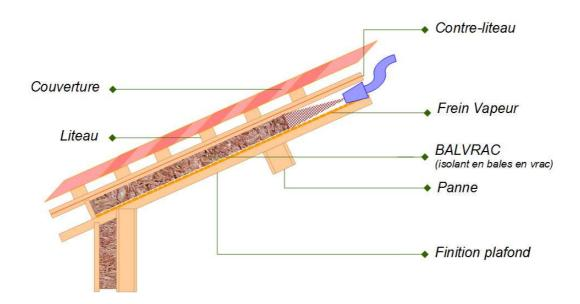
Exemple d'isolation par insufflation (Toiture vue en coupe)
